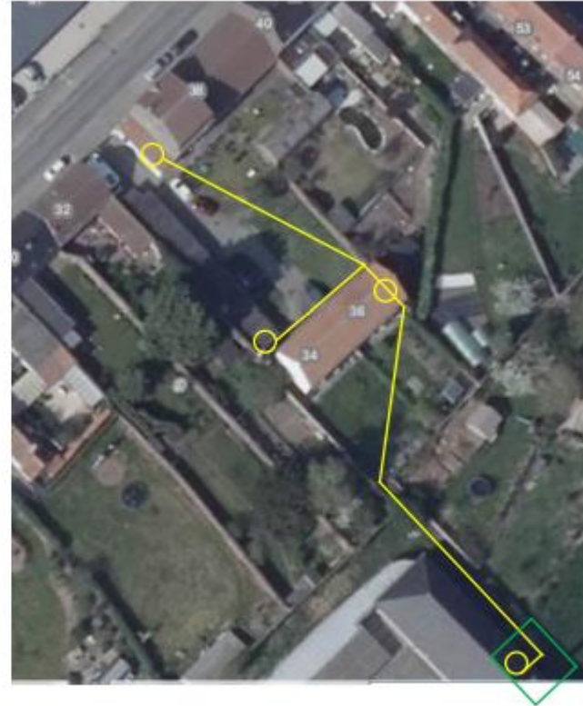
Réseau de chaleur organisé en 2 branches. Vers l'aide « Cuisine » de l'école et vers les logements de la régie foncière communale
