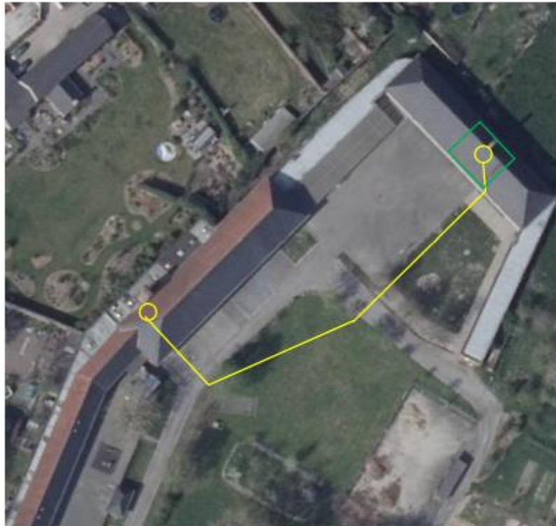
Réseau de chaleur organisé en 2 branches. Vers l'aide « Cuisine » de l'école et vers les logements de la régie foncière communale
