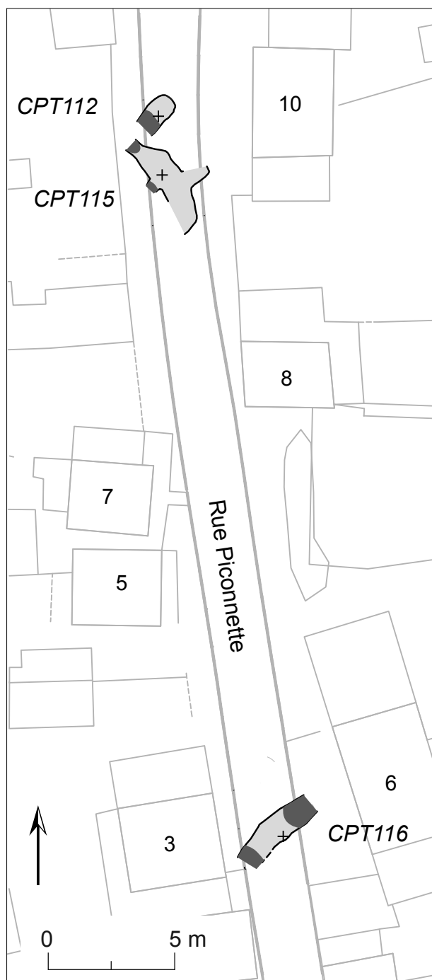
Situation des galeries repérées par forage sous la rue Piconnette en 2014, © Service d'Inspection générale des Carrières (France, départements des Yvelines, du Val d'Oise et de l'Essonne).
