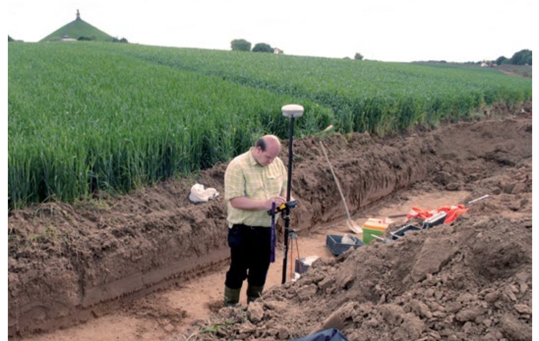
Pierre-Michaël Warnier, du service de géomatique du SPW, effectue un relevé topographique du squelette à l'aide d'un GPS haute précision.
